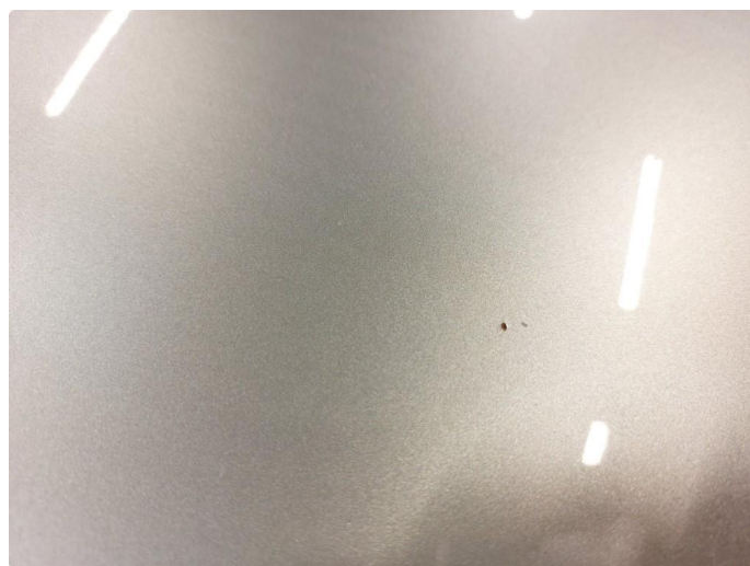
2.4 Steinsprut med rust
