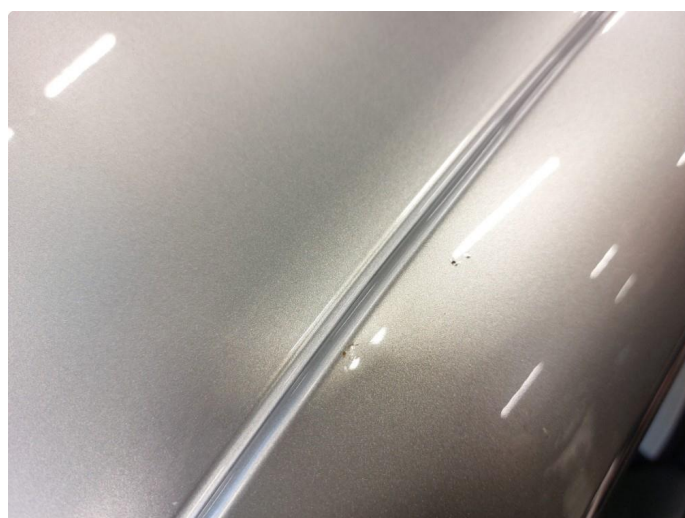
2.4 Steinsprut med rust
