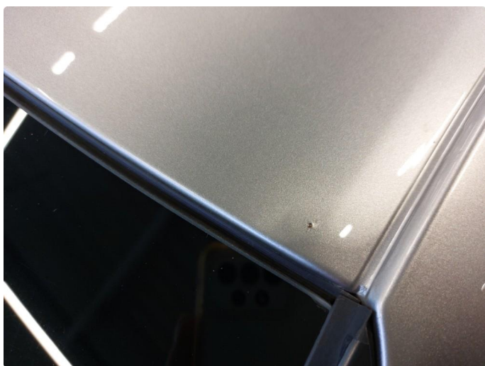
2.4 Steinsprut med rust
