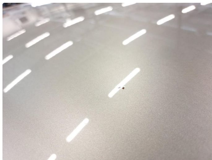
2.4 Steinsprut med rust
