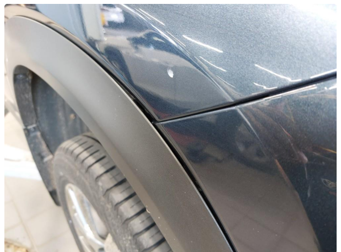
1.4 Litt skjev innfestning
