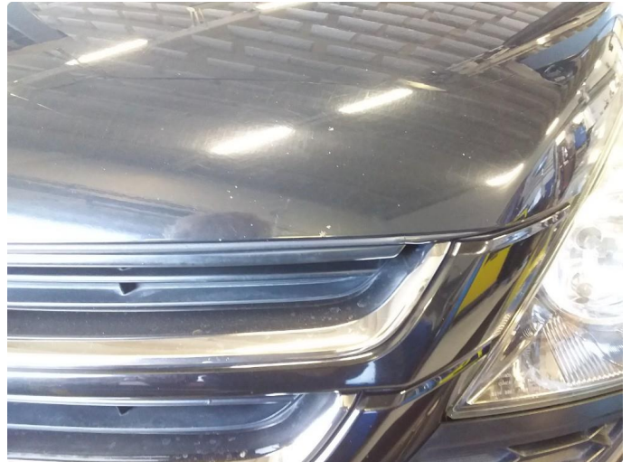
1.2 Noe steinsprut med rust
