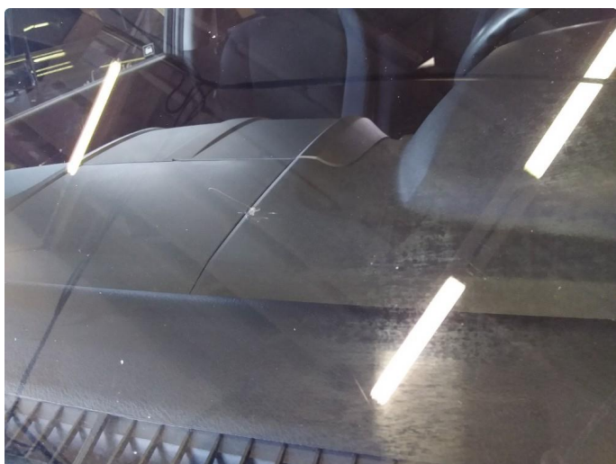
1.13 Steinsprut med sprekk
