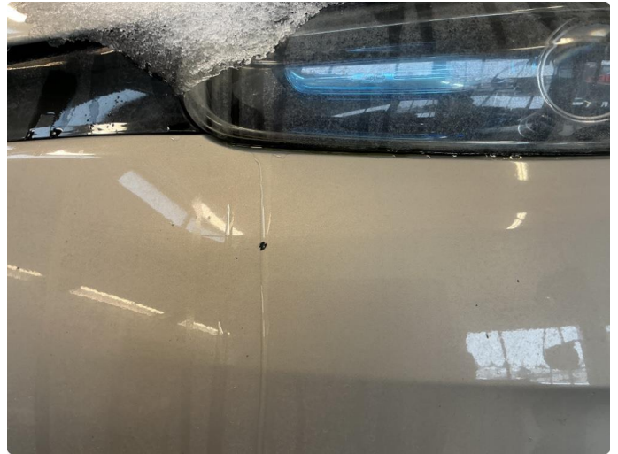
1.3 Flekk etter stensprut front plastfanger
