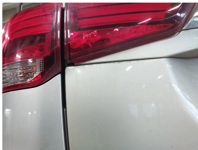
2.1 Defekt / sprukket glass
