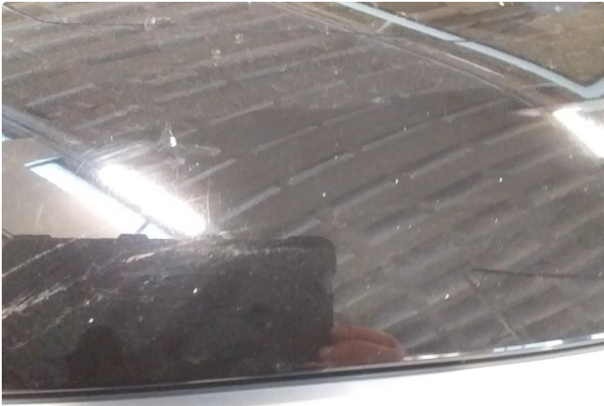
1.1 Noe steinsprut med rust
