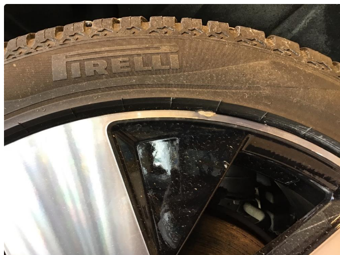
1.2 Liten skade i felg
