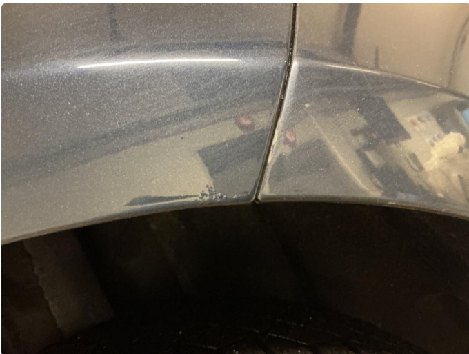
1.3 Antydning til korrosjon i begge skjermmer bak
