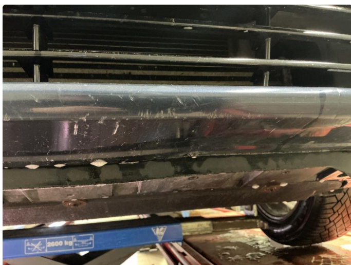
1.5 Skrubbskader underkant av støtfanger, ikke synlig fra stående prsjon
