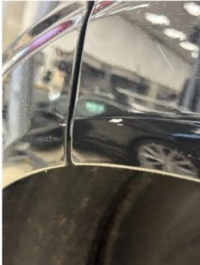
1.1 Lita ripe i skjerm/dør venstre bak. Dempes med rubbing og polering
