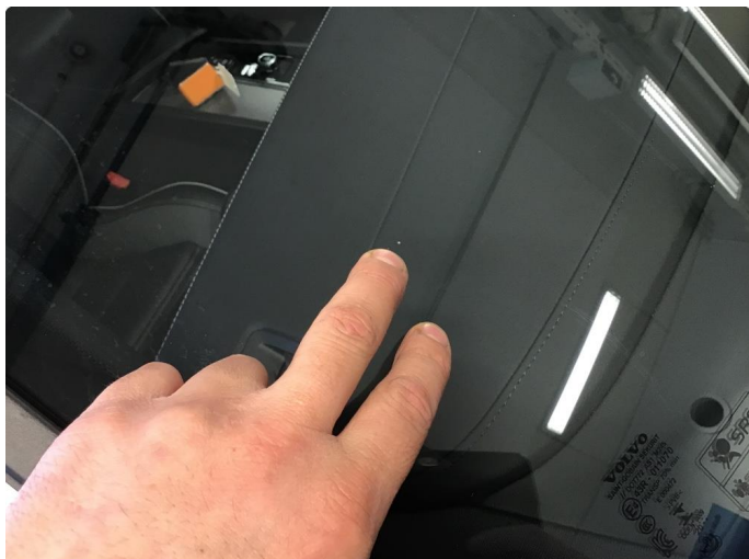
1.1 Liten steinsprut. Reparert
