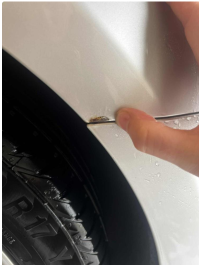
1.9 Lakk flasser. Dette er pusset og lakkert over
