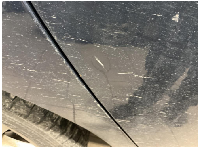
1.2 Parkeringsbulk høyre bakdør
