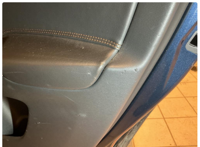
2.1 Skadet/merker etter utstyr
