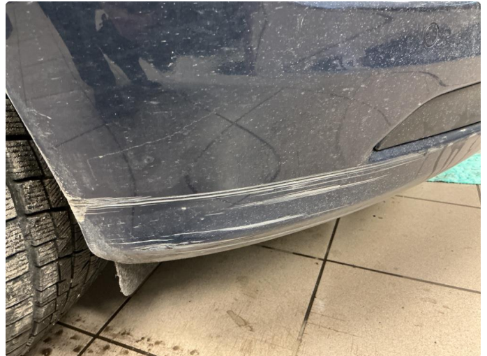
1.3 Riper støtfanger. Poleres bort etter beste evne
