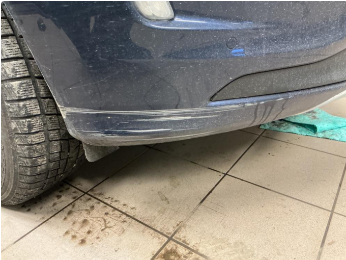
1.3 Riper støtfanger. Poleres bort etter beste evne
