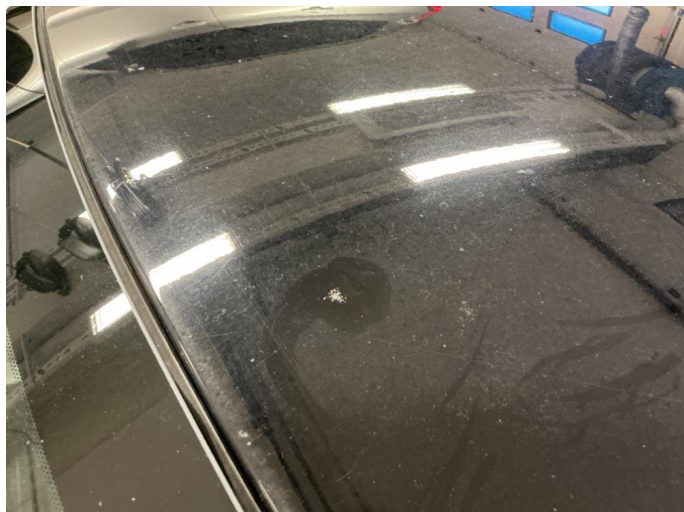
1.4 Steinsprut med rust
