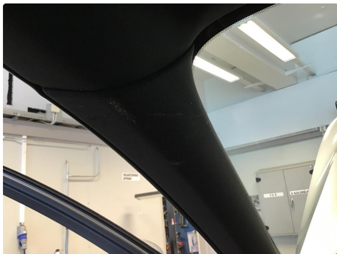
2.2 Liten skade i taktrekk
