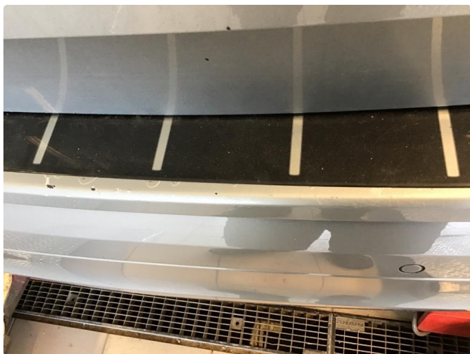
1.3 Litt lakk som flasser fra bakfanger
