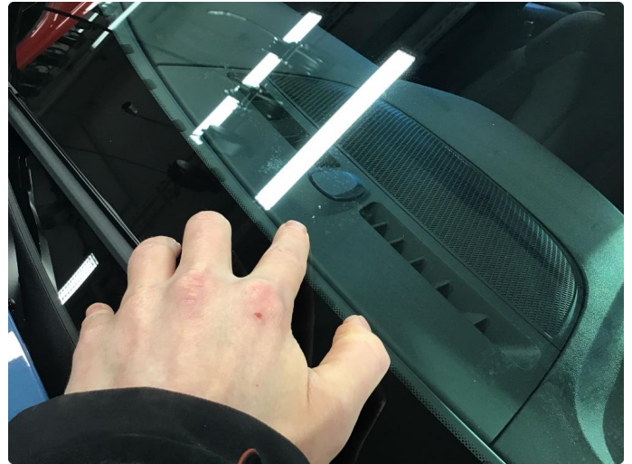
1.2 Liten steinsprut nederst på frontrute
