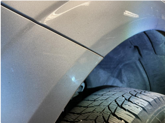
1.1 Små lakkskader/slitasje rundt hjulbuer
