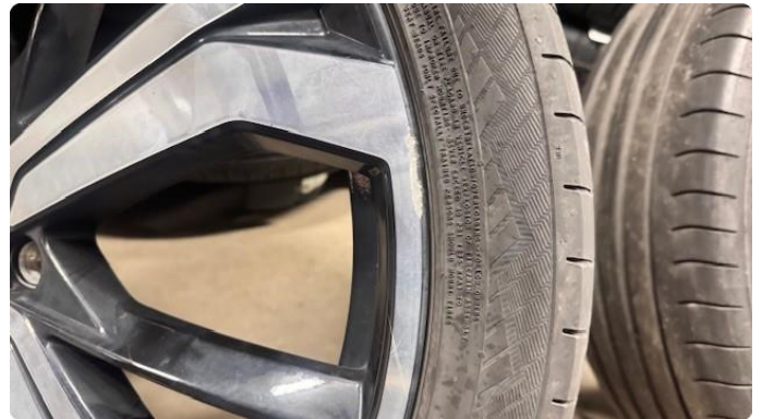
1.1 Liten kantkjøring på en felg, og liten skade på en annen
