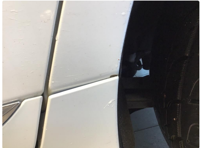
1.2 Små antydninger til rust på hjulbuer
