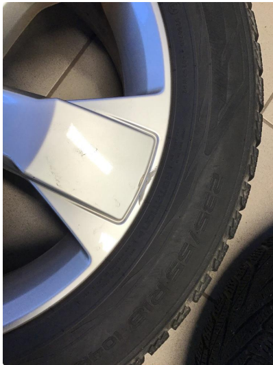
1.2 Liten skade på vinterfelg
