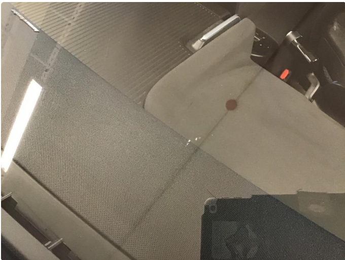
1.3 Liten steinsprut frontrute
