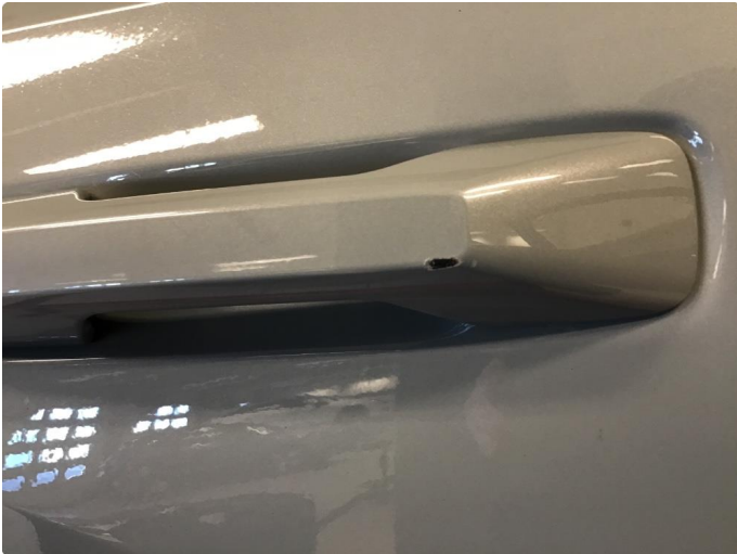
1.1 Liten lakkskade på h.b håndtak ( vil bli flekkklakkert)
