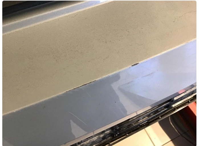
1.2 Liten lakk skade på kant av bakfanger ( vil bli flekkklakkert)
