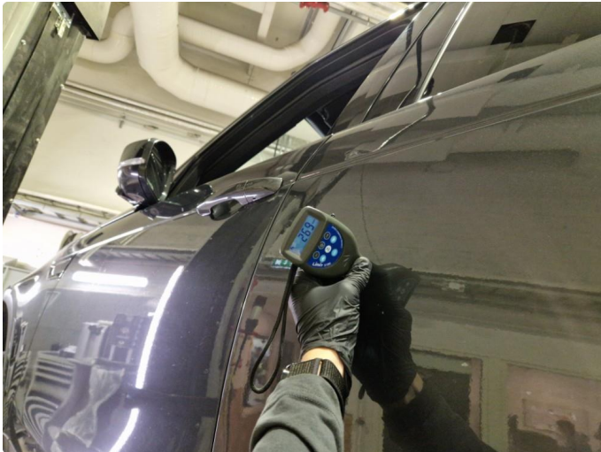
1.1 Noe støvkorn i lakk på venstre side, poleres.
