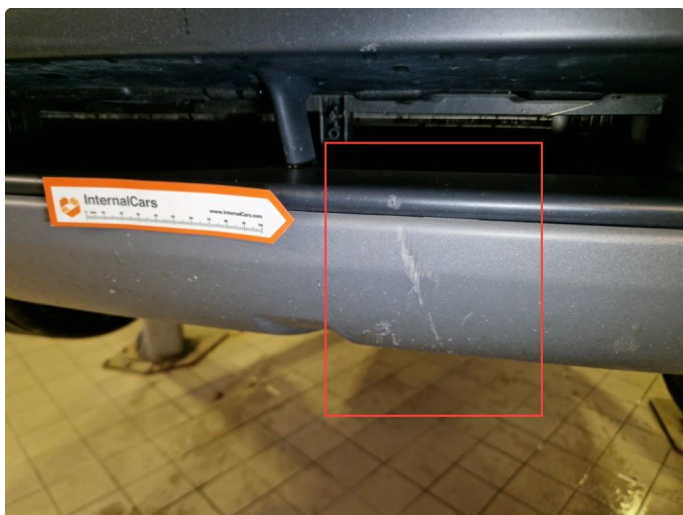
1.6 Noe riper / merker nedre del frontfanger ( Normal bruksslitasje )
