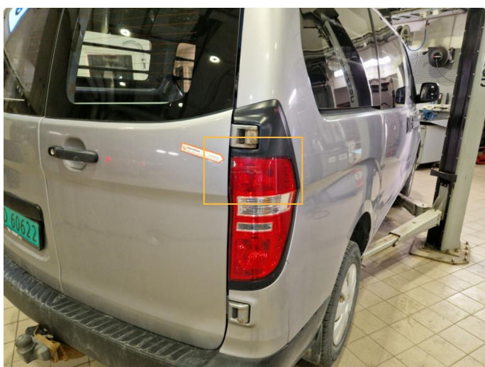
2.1 Sprekkdannelser lykteglass h baklykt.
