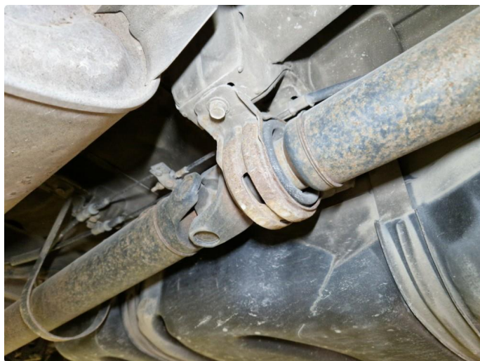
6.1 Slitasje oppheng til mellomaksel.
