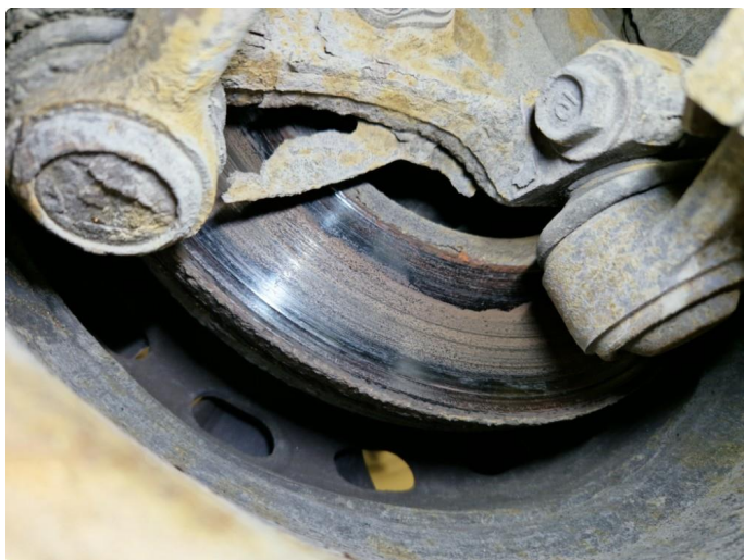
5.1 Noe slitasje / rust bremseskiver fram.
