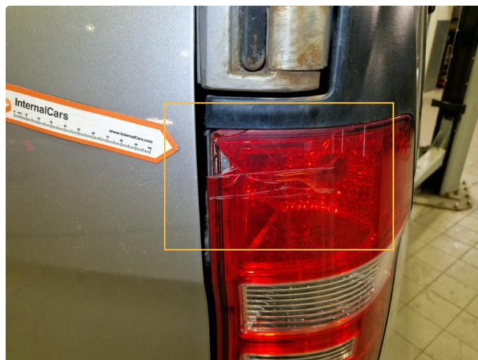
2.1 Sprekkdannelser lykteglass h baklykt.
