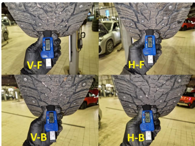
1.3 Dekkdybdemåling vinterdekk utført 29.04.2026 på km : 208.175.
