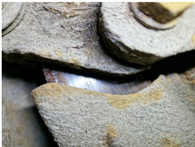
5.2 Noe slitasje / rust bremseskiver bak.
