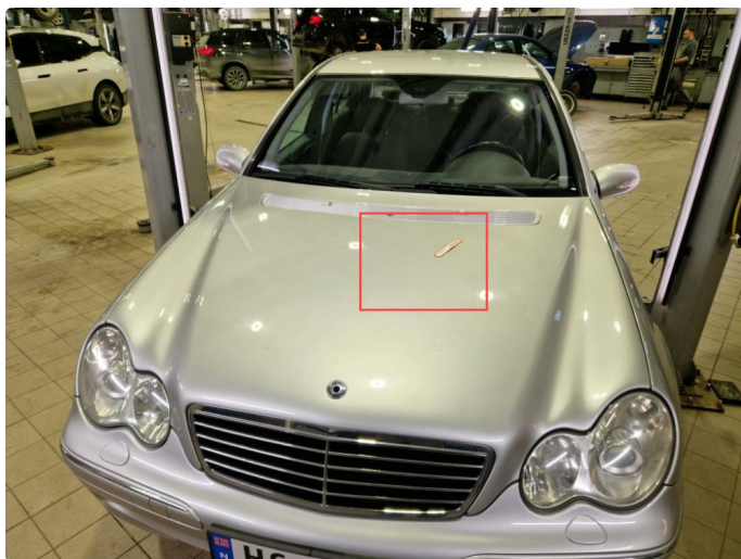
2.2 Noe steinsprut panser + manglende stjerne logo.
