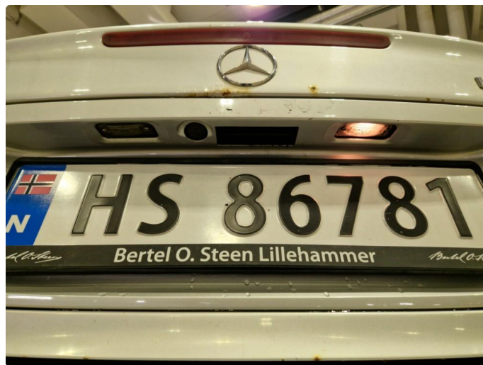
3.1 Defekt skiltlyspære v-side.
