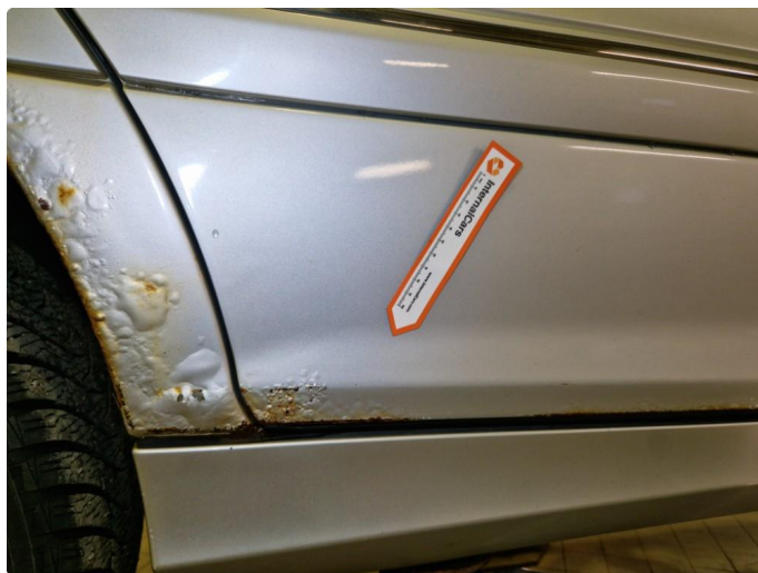
2.3 Rust nedre del alle 4 stk dører.
