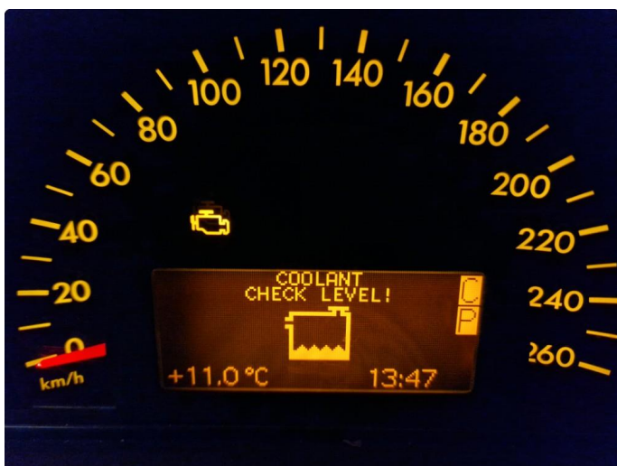
1.4 Feilmelding kjølevæsknivå, kjølevæsknivå OK.
