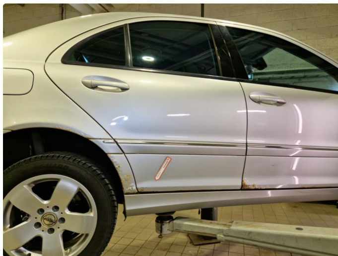
2.3 Rust nedre del alle 4 stk dører.
