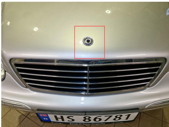
2.2 Noe steinsprut panser + manglende stjerne logo.
