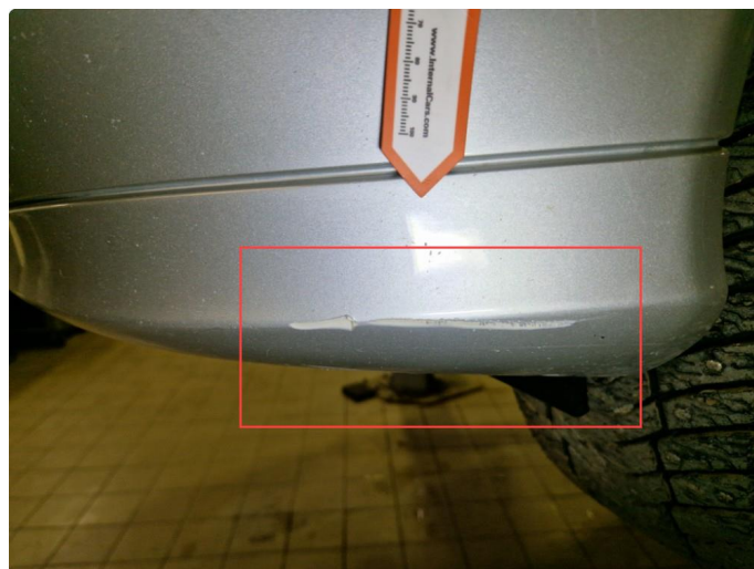
2.9 Riper / lakkskade nedre del v-side frontfanger.
