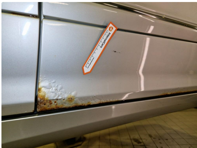
2.3 Rust nedre del alle 4 stk dører.
