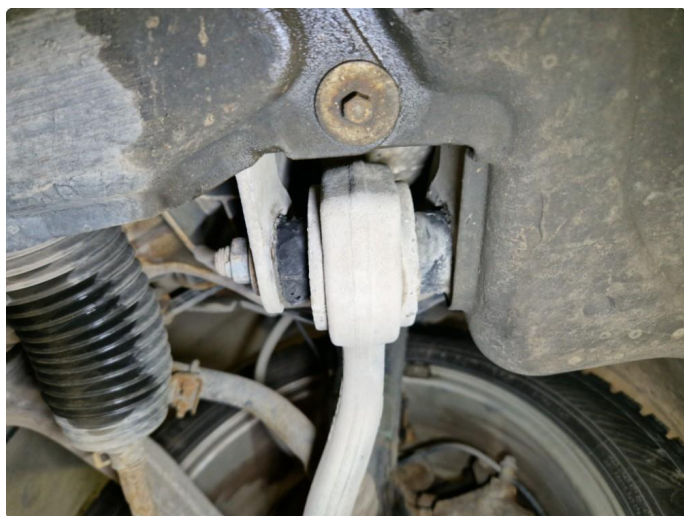
5.4 Utslitt indre / bakre bæreamsforing h+v fram.
