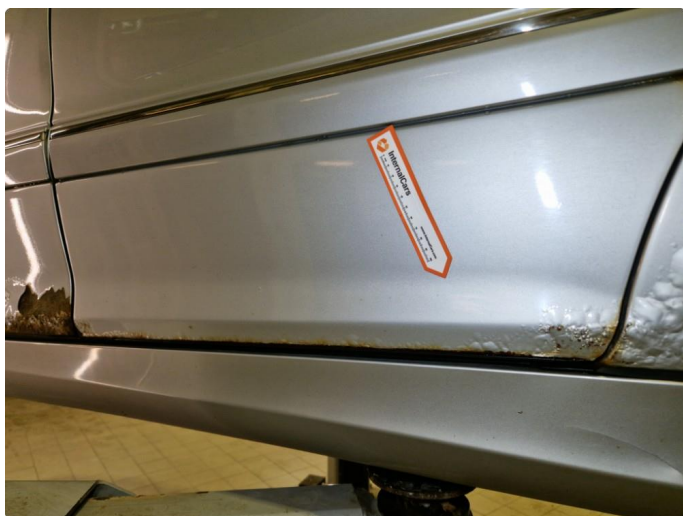
2.3 Rust nedre del alle 4 stk dører.
