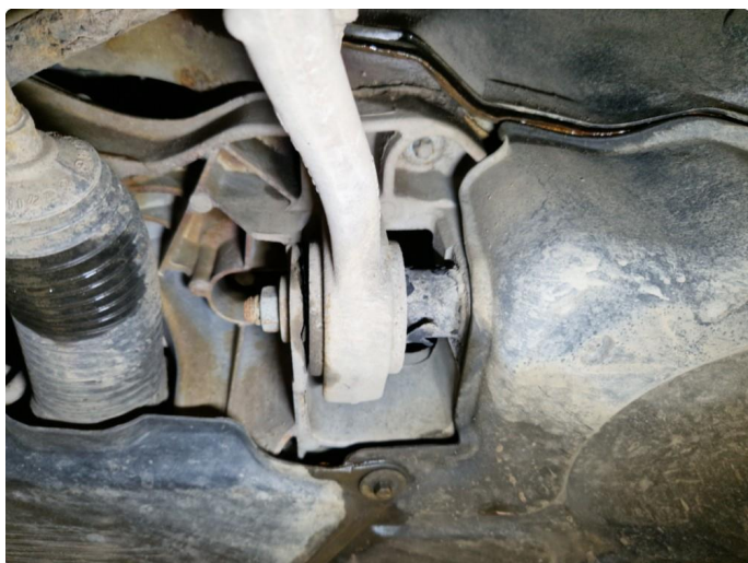
5.4 Utslitt indre / bakre bærearmsforing h+v fram.
