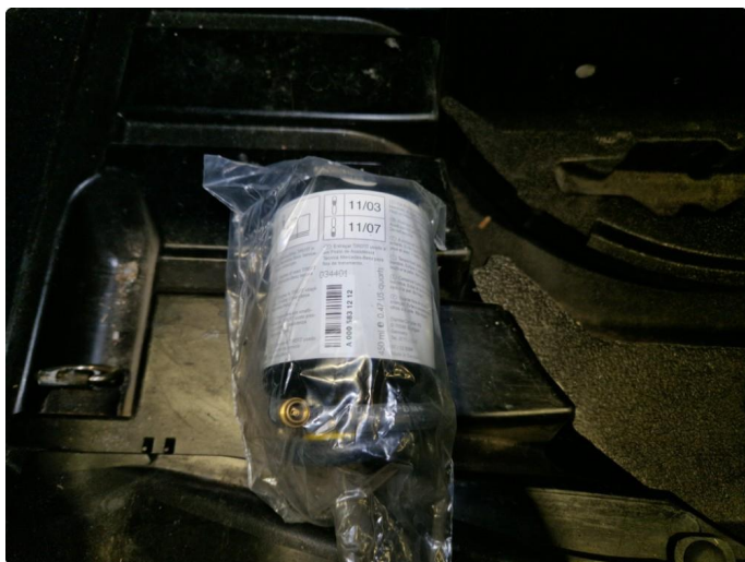
2.6 Dekktettermiddel utgått på dato 11/2007.
