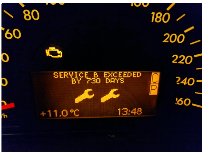
4.1 Lyser for service 730 dager siden.
