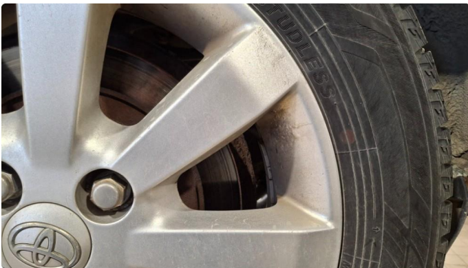
1.7 Korrosjon og fastbrent rust.
