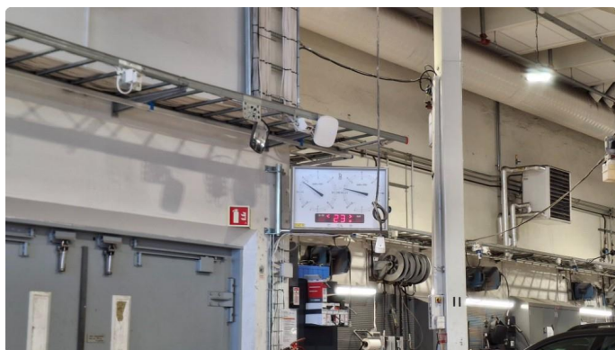
5.2 Forskjell i bremsekraft > 30% av høyeste verdi.
