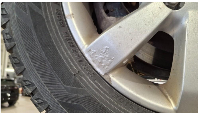
1.7 Korrosjon og fastbrent rust.
