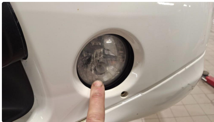
4.1 Tåkelys - defekt / sprukket glass
