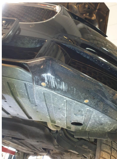
1.2 Skrubbskader underkant Foran
