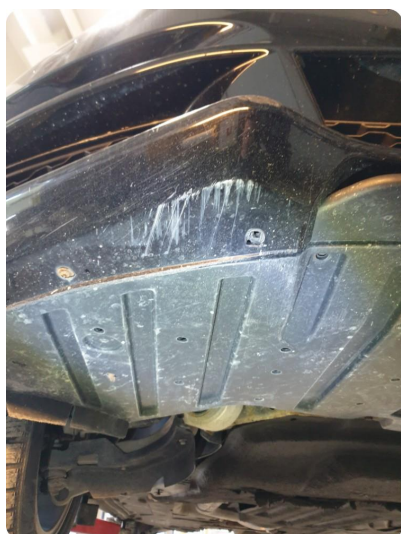
1.2 Skrubbskader underkant Foran
