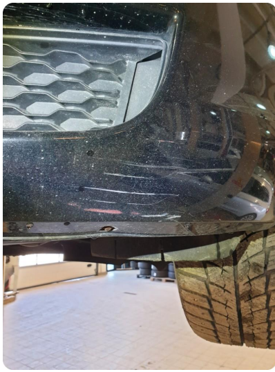
1.2 Skrubbskader underkant Foran
