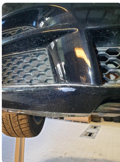
1.2 Skrubbskader underkant Foran
