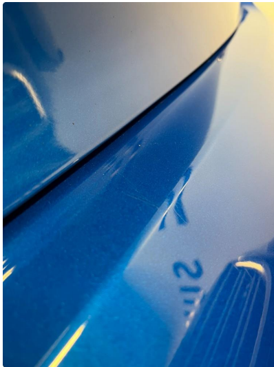
1.3 Lien ripe på bakfanger, bør gå bort ved polering
