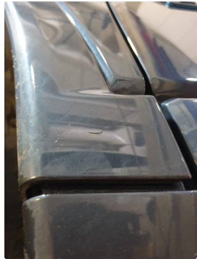
1.1 Forurensing lakk ytre påvirkning
