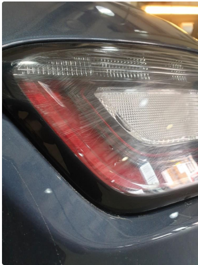
1.1 Forurensing lakk ytre påvirkning
