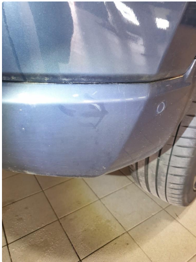
1.1 Forurensing lakk ytre påvirkning
