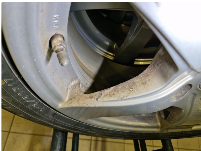
2.9 Korrosjon alle vinterfelger.
