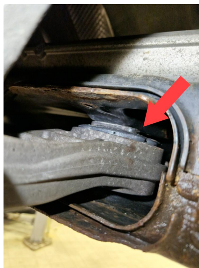
4.3 Defekt nedre bakre motorfeste, gummi har sluppet i vulking.
