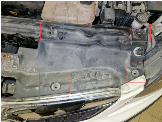
2.1 Støymatte/deksel løst. Mangler flere klips pyntedeksel motorrom.
