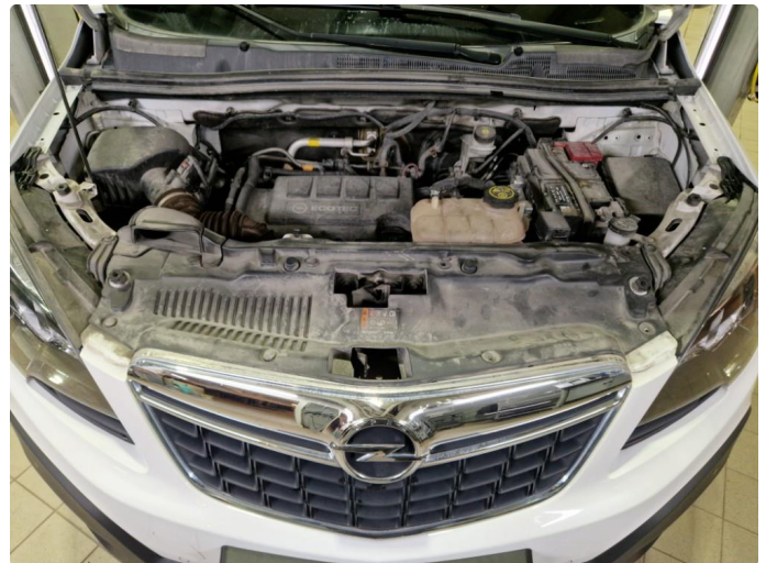
2.1 Støymatte/deksel løst. Mangler flere klips pyntedeksel motorrom.
