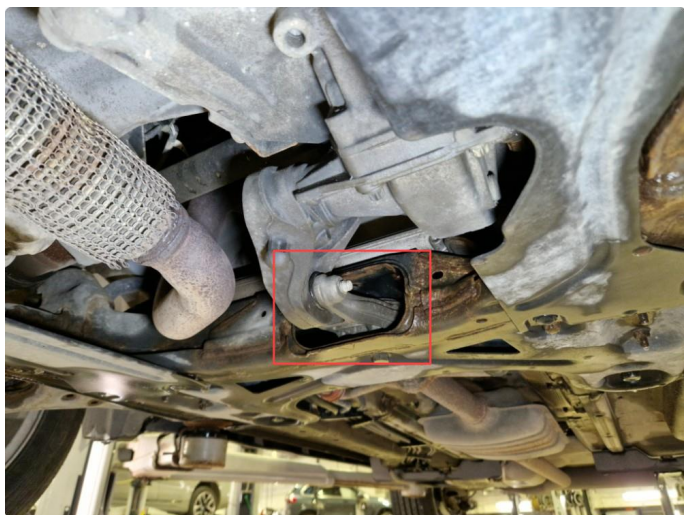
4.3 Defekt nedre bakre motorfeste, gummi har sluppet i vuling.
