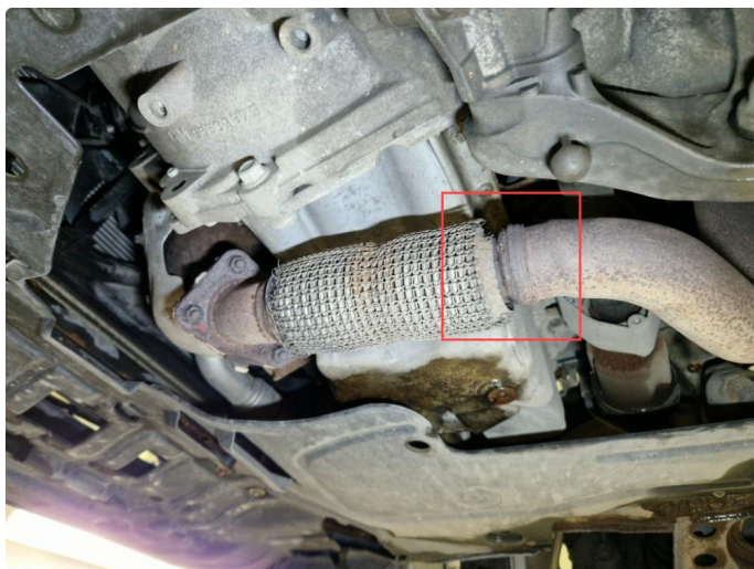
4.1 Defekt flexikobling , noe eksoslekkasje.
