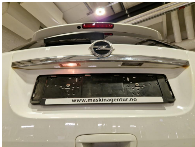
3.3 Defekt skiltlyspære hside ( Byttes pære ).
