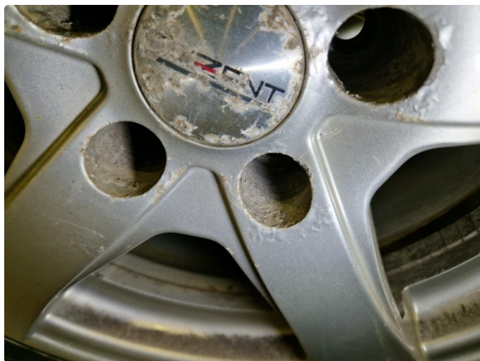
2.9 Korrosjon alle vinterfelger.
