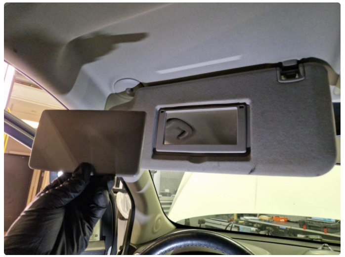
7.1 Skadet deksel over speil i solskjerm v-side.
