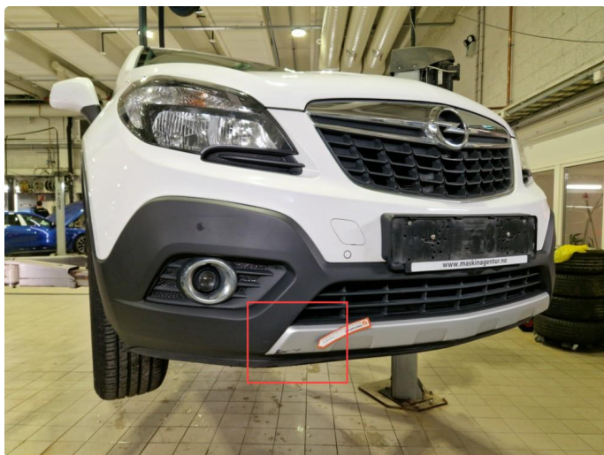
2.11 Skadet nedre del frontfanger hside + skrubbskader midtre del.
