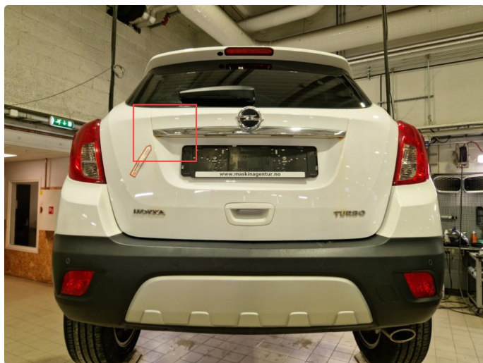
2.4 Rust bakluke ved lyslist h+v side.
