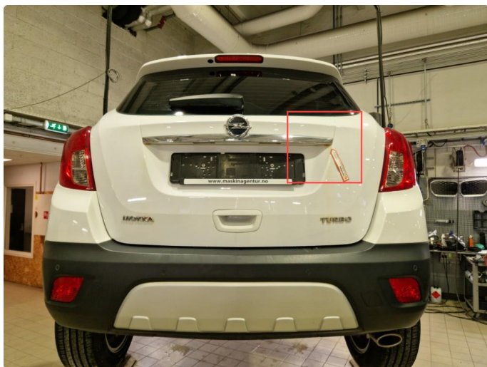
2.4 Rust bakluke ved lyslist h+v side.
