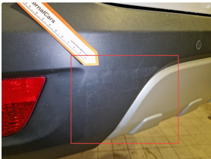
2.12 Noe merker bakfanger v-side.
