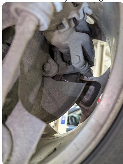
6.1 Bremsen ligger på Brems henger på bak, verst v. bak, skiver er noe rødlige, bør gjøres et forsøk på demontering, rengjøring og oppsmøring, er også en begynnende rustkant på innsiden.
