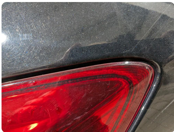
3.3 Krakelering i plast Krakkelering i baklykter, værst v. side, men er begynnende også h. bak
