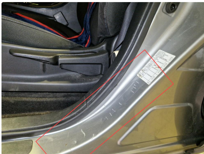
2.15 Lakkskader / slitt innsteg / b-stolpe v-fram.
