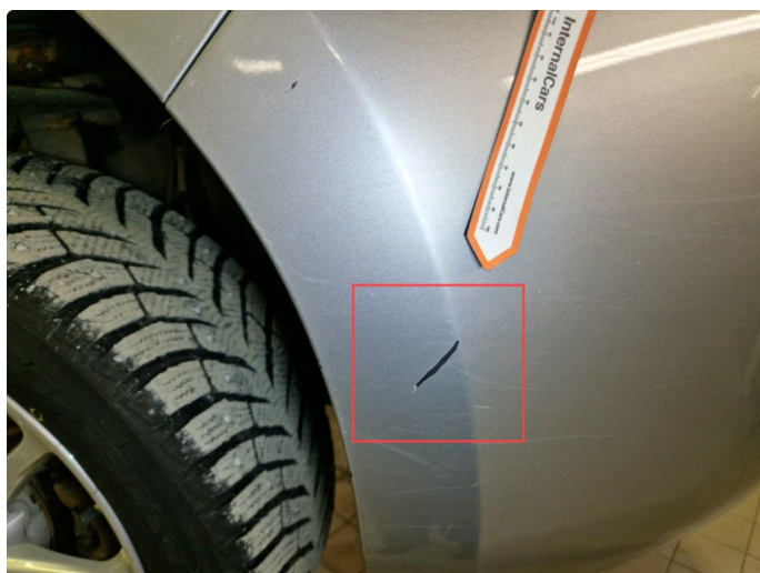
2.16 Riper / lakkskader frontfanger.
