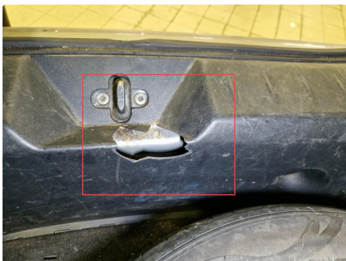
6.1 Skadet deksler i bagasjerom.
