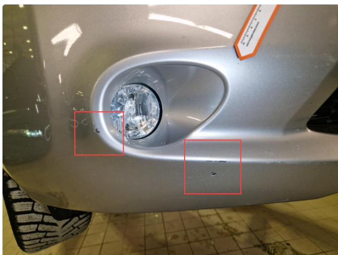
2.16 Riper / lakkskader frontfanger.
