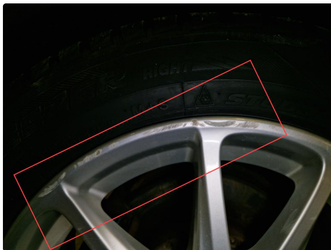
2.12 Bruksmerker vinterfelg h-bak.
