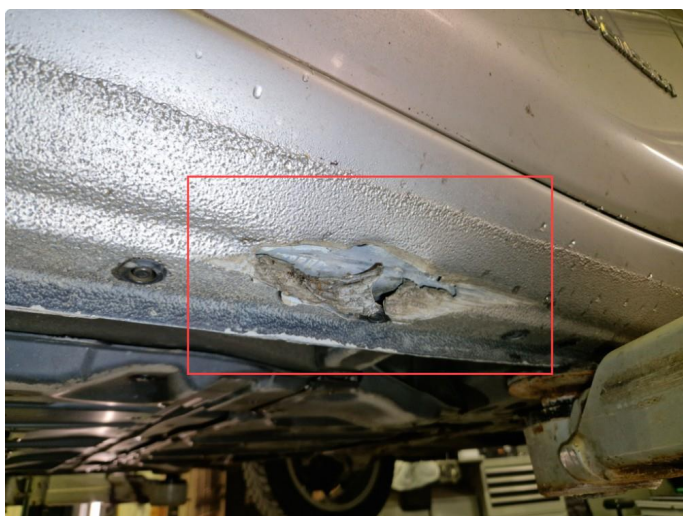
2.19 Skade kanal h-side.
