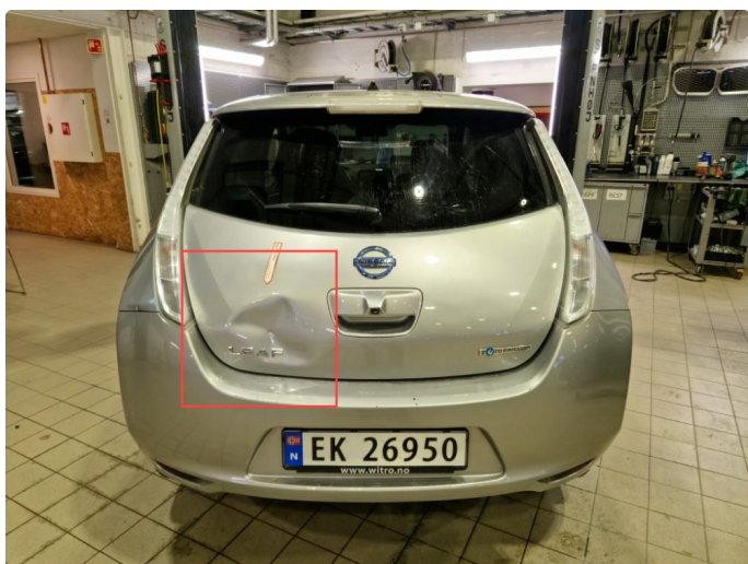
2.5 Bulk / skade bakluke.
