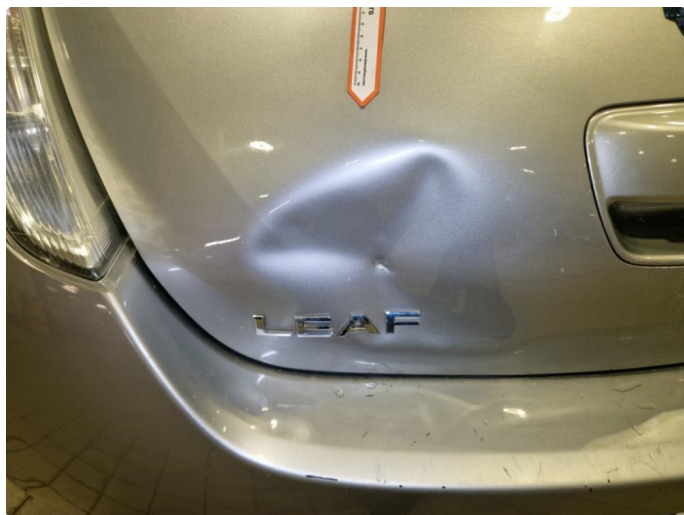
2.5 Bulk / skade bakluke.
