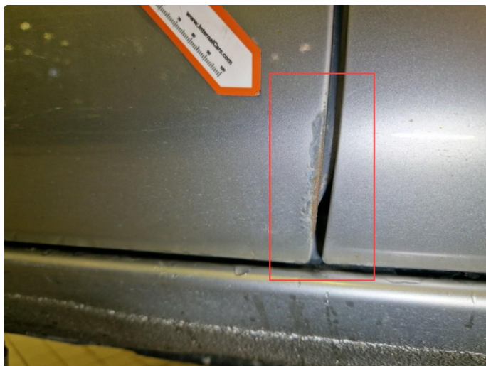
2.3 Rust / bruksmerker h-bakdør.
