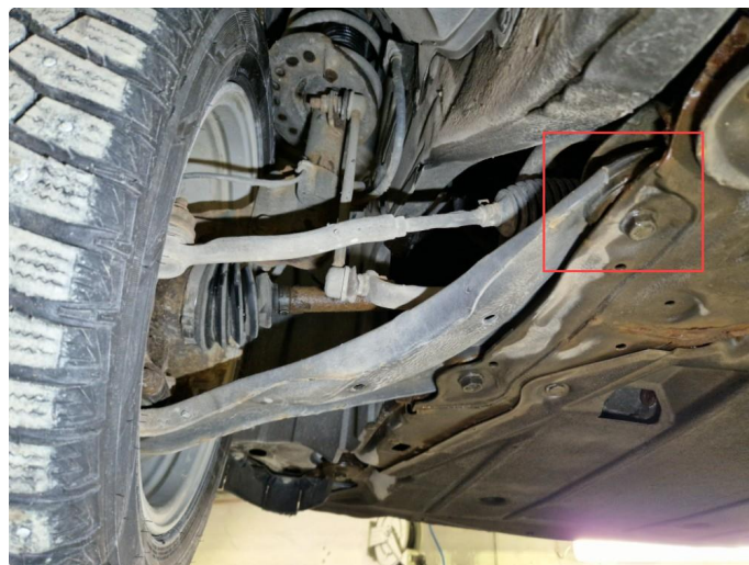
4.2 Utslitt bakre bæreamsforing / sluppet i vulking h+v side fram.
