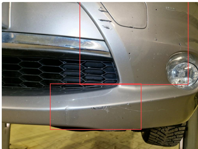
2.16 Riper / lakkskader frontfanger.
