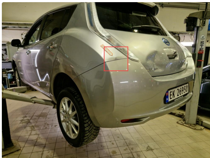
2.7 Bulk / bruksmerker v-bakskjerm.
