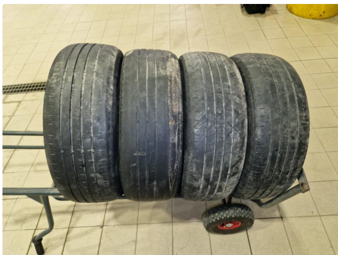
2.11 Sommerdekk utslitt. Compas / JL Blazer HP 205/55r 16 91V .
