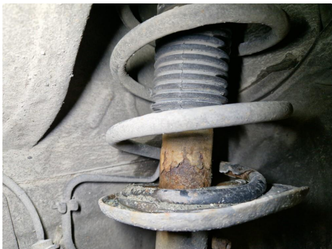
4.1 Rustdannelser fjærbein h+v side fram.
