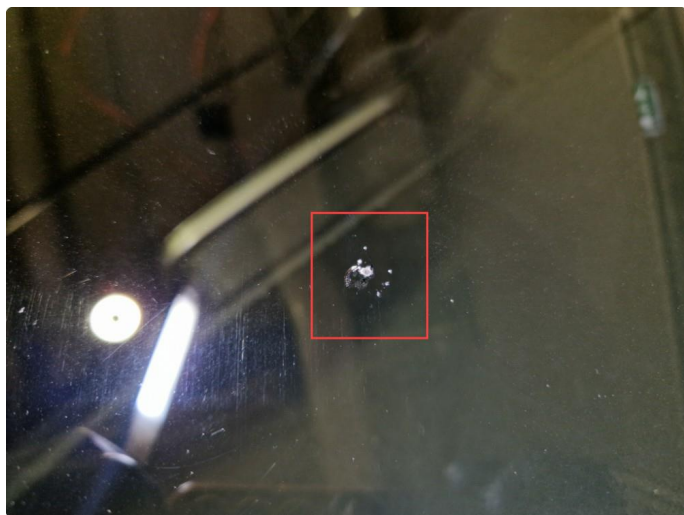
2.18 Riper / steinsprut / slitasje frontrute.
