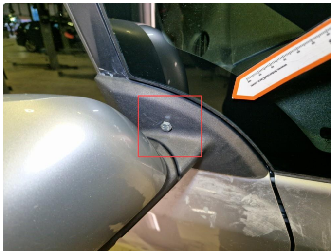
2.10 Innfesting av speilfot h-side er festet med uoriginal bolt fra utsiden.
