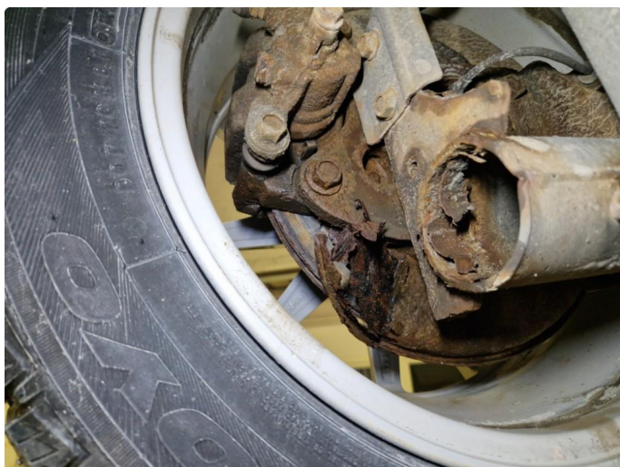
5.1 Gjennomrustet bremseskjold h+v side bak.
