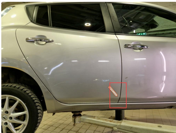
2.3 Rust / bruksmerker h-bakdør.
