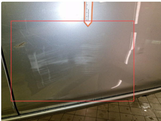
2.4 Bulker / bruksmerker h-framdør.
