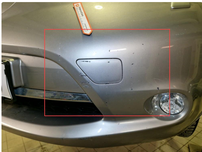
2.16 Riper / lakkskader frontfanger.
