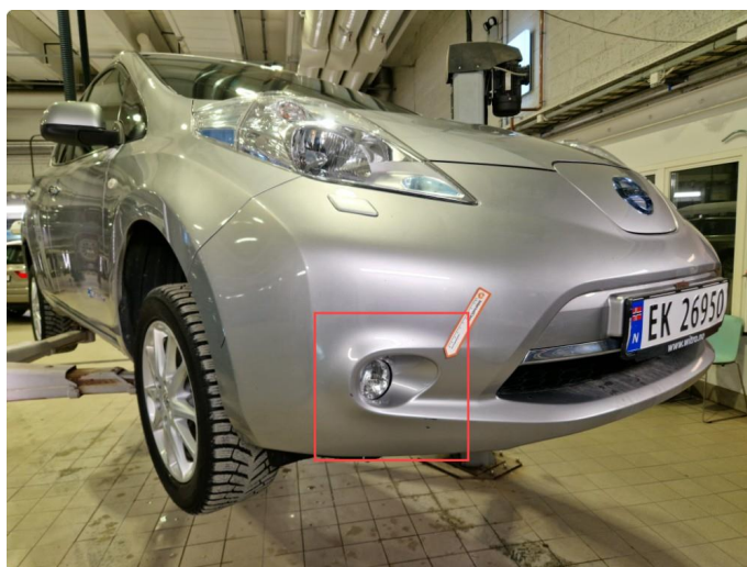
2.16 Riper / lakkskader frontfanger.
