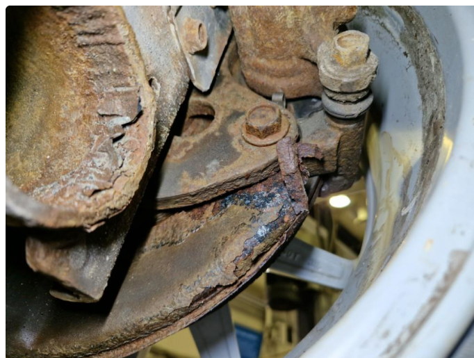
5.1 Gjennomrustet bremseskjold h+v side bak.
