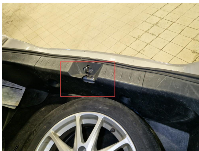
6.1 Skadet deksler i bagasjerom.
