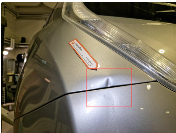
2.7 Bulk / bruksmerker v-bakskjerm.
