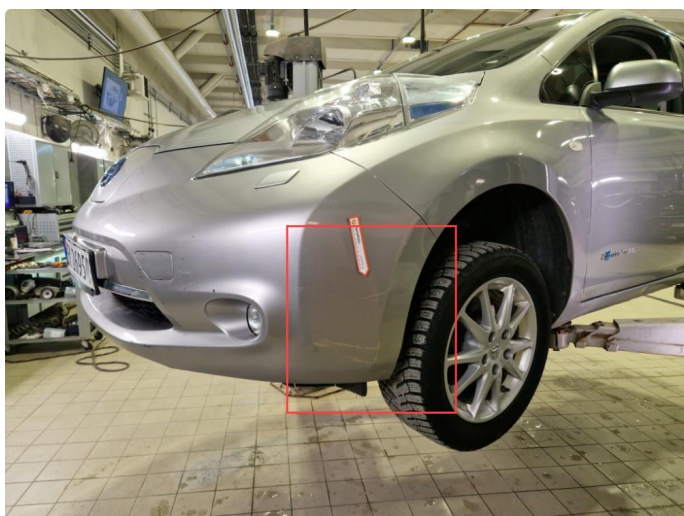
2.16 Riper / lakkskader frontfanger.
