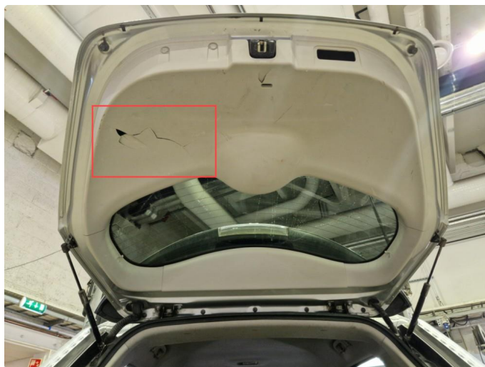
6.1 Skadet deksler i bagasjerom.
