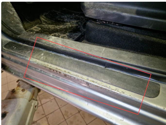
2.15 Lakkskader / slitt innsteg / b-stolpe v-fram.
