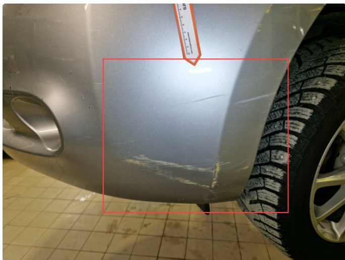
2.16 Riper / lakkskader frontfanger.
