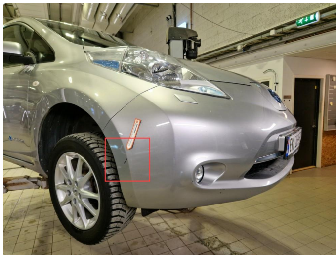
2.16 Riper / lakkskader frontfanger.
