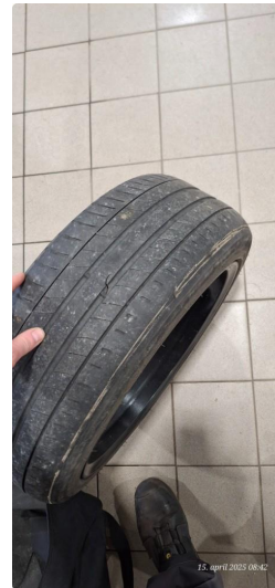
2.5 Skjev slitasje på sommerdekk
