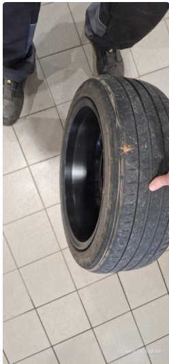
2.5 Skjev slitasje på sommerdekk
