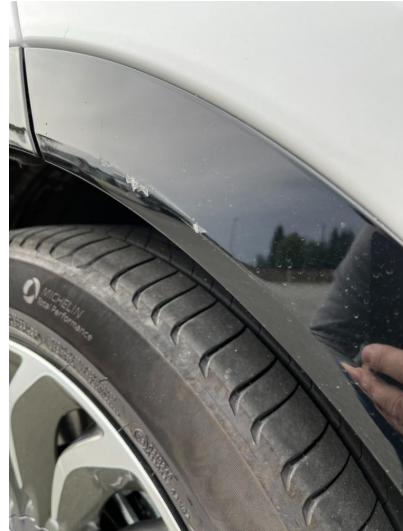
1.2 Skrubbskade plast høyre bak
