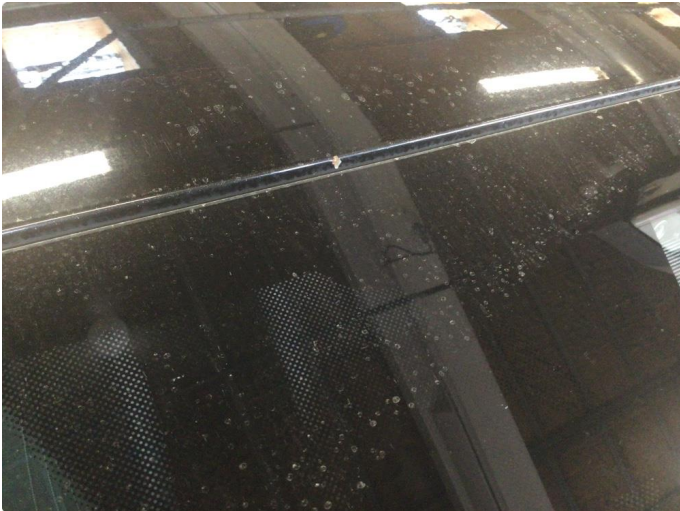
1.1 Steinsprut med rust
