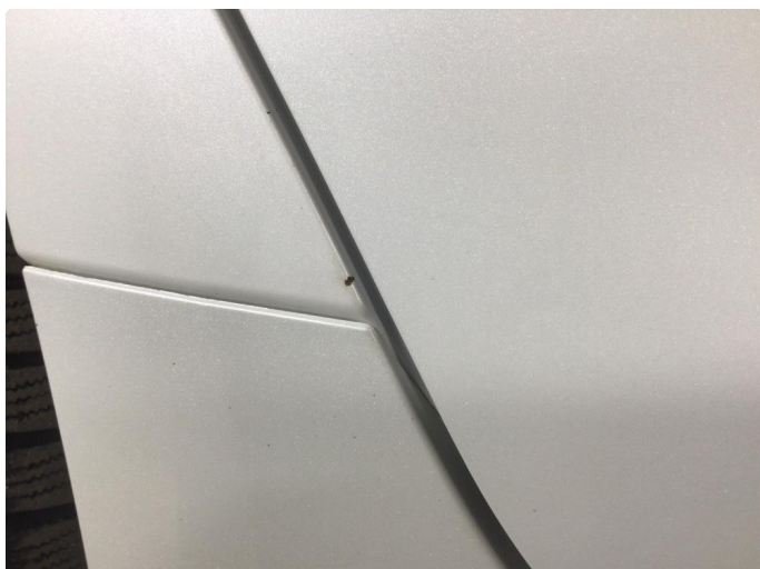
1.1 Steinsprut med rust
