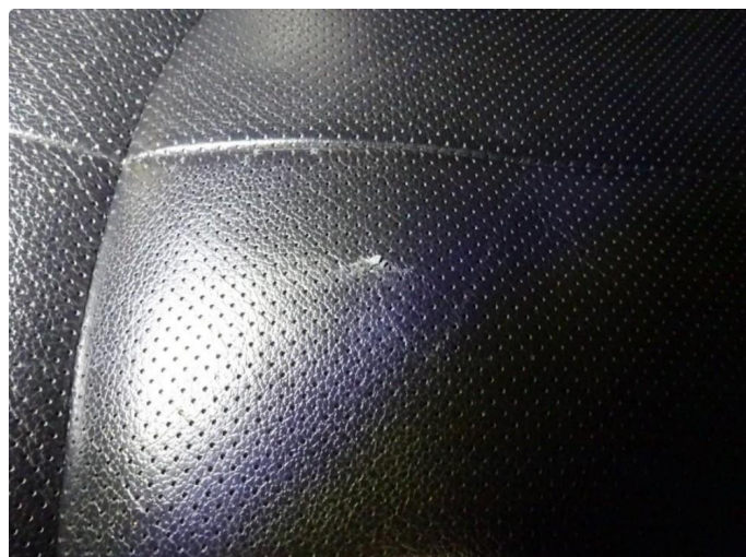
3.1 Liten rift i skinn på førerstol. Kan repareres med salmaker.
