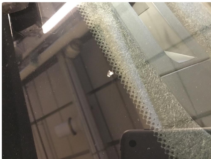
1.2 Steinsprut med sprekk
