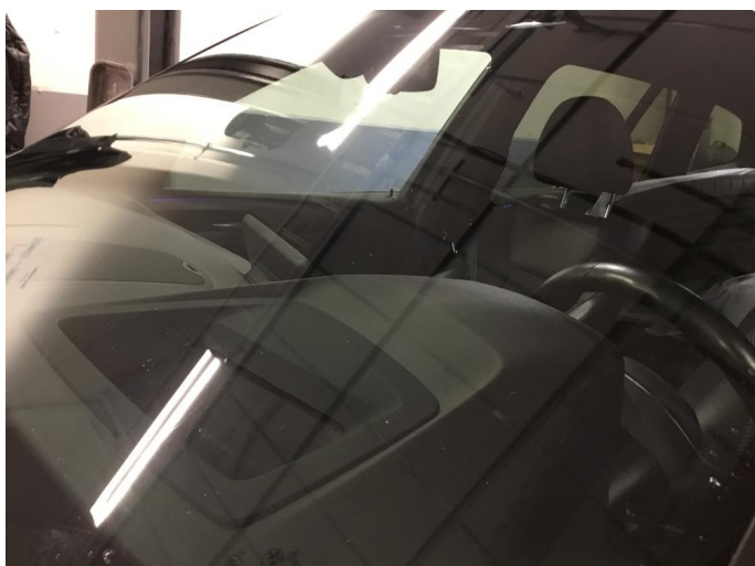
1.2 Noe steinsprut i frontrute
