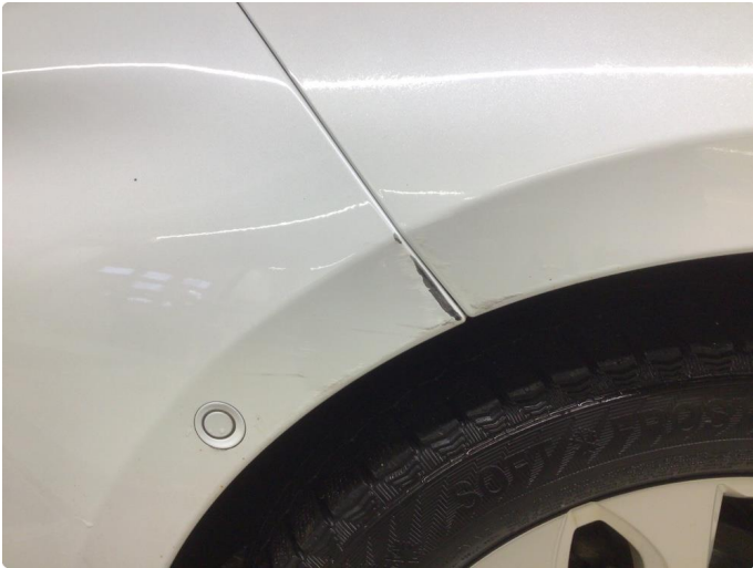
1.1 Ripe(r) ned til grunning
