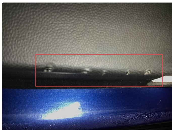
3.1 Noen merker i dørtrekket på førerdør.
