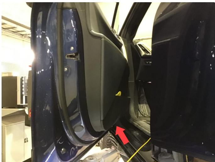
3.1 Noen merker i dørtrekket på førerdør.
