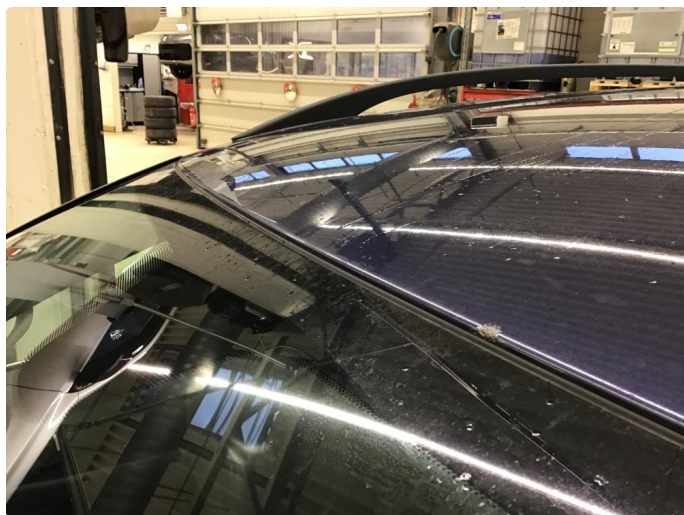
1.3 Steinsprut med rust
