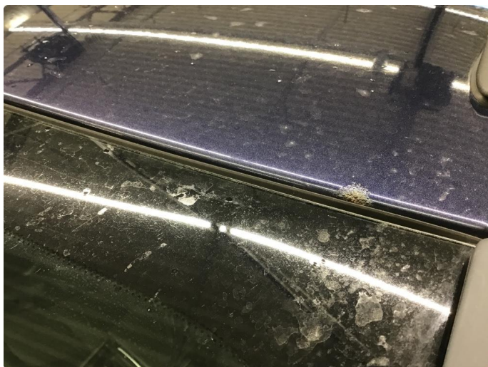
1.3 Steinsprut med rust
