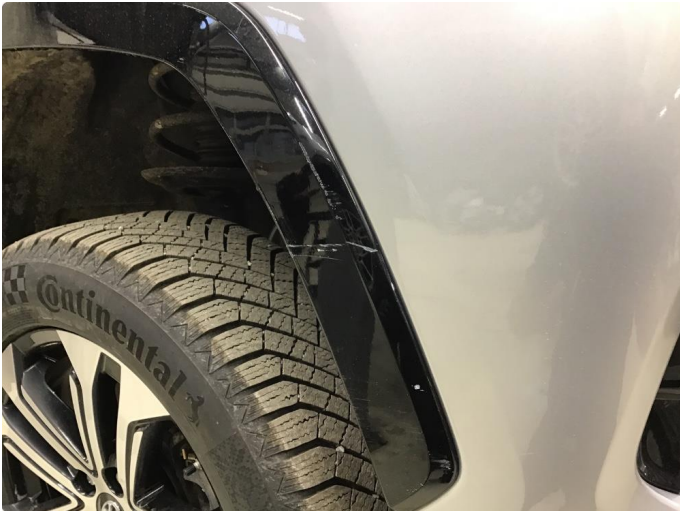
1.1 Ripe(r) ned til grunning
