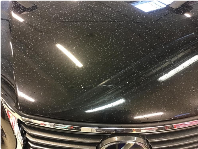
1.1 Noe steinsprut med rust
