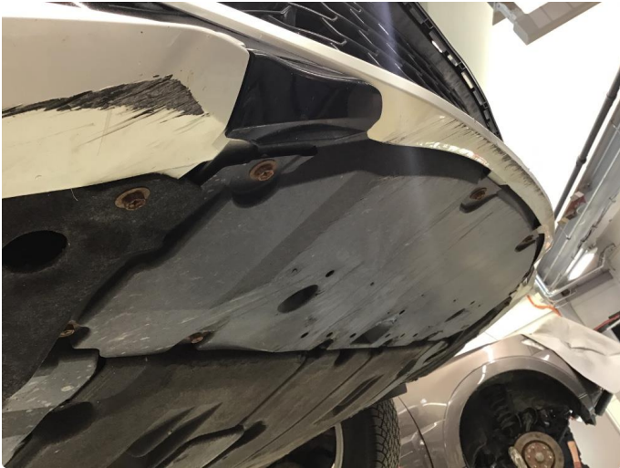
1.1 Skrubbskader underkant plast
