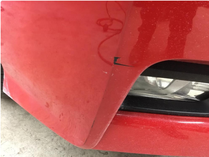
1.1 Ripe(r) ned til grunning
