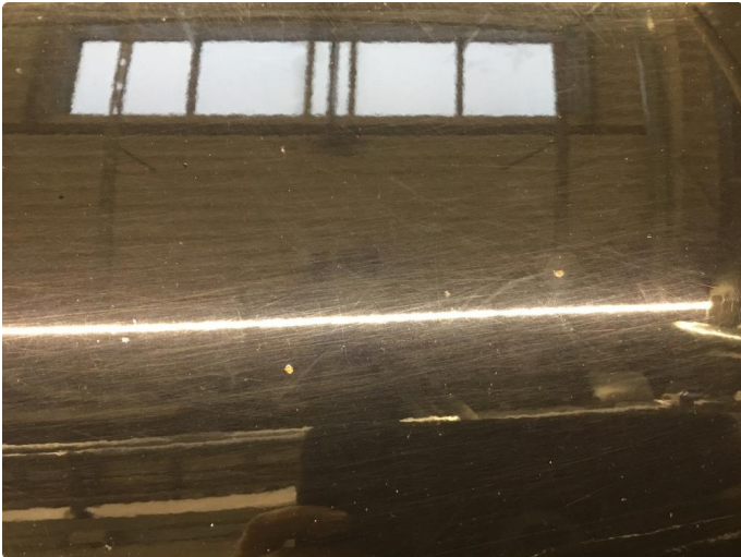
1.1 Noe steinsprut med rust
