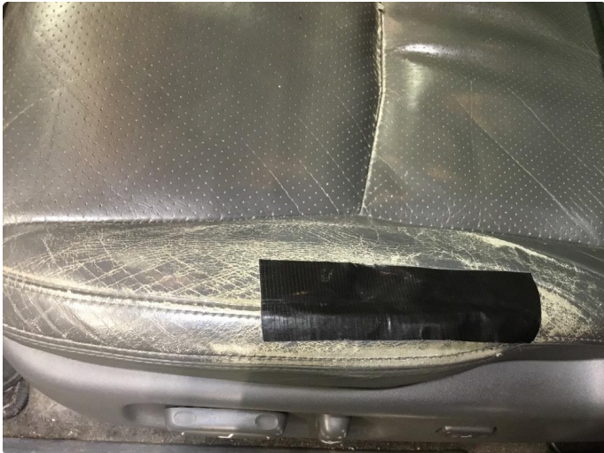
1.1 Skade på setetrekk
