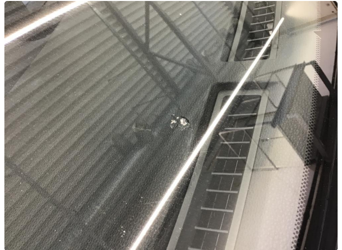
1.2 Steinsprut med sprekk utenfor synsfelt
