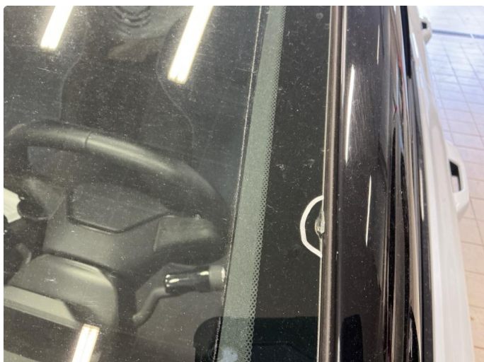
1.1 Steinsprut. Blir byttet frontrute.
