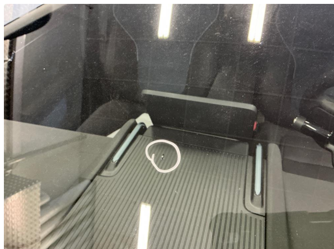
1.1 Steinsprut. Blir byttet frontrute.
