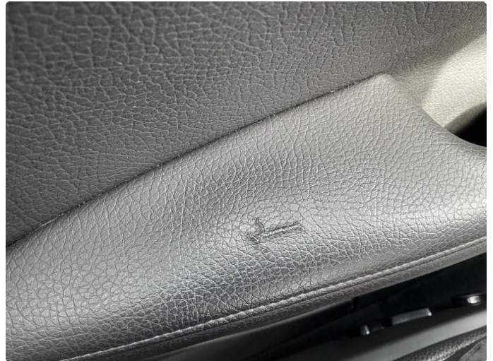
1.1 Rift i dørtrekk på føredør.
